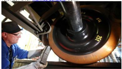
© dpa Wird jetzt alles gut? Ein Techniker der Bahn montiert einen neuen Bremsklotz ein
