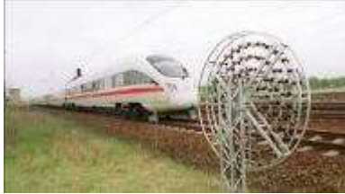
Schallmessung an einem Bahngleis
